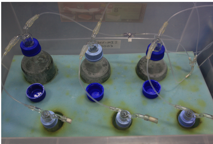
Figura 6. Montaje para la obtención del carbono orgánico disuelto volátil. Foto: M. Nieto Cid
